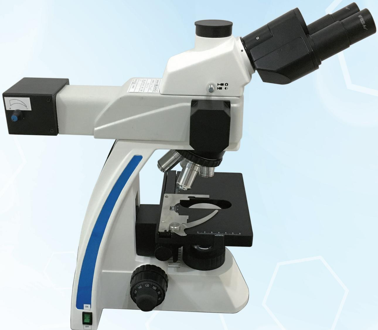
MF31生物显微镜采用无限远平场消色差物镜和大视野目镜，可用双目或三目观察，搭配LED荧光激发装置，实现明场和荧光显微观察，供临床实验室利用显微放大原理观察微小细胞、组织等样本用。
